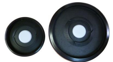
C-OPS(左)とPRR-810(右)ハウジング径の比較
