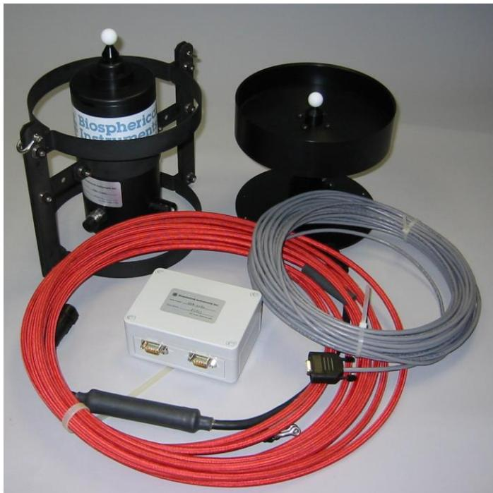
*Scaler PAR Profiling* システムは、野外での研究に最適なポータブル水中スカラー光量子計です。水中の光合成有効放射(PAR 波長域:400-700nm)を地上比較センサ値と比較しながら測定します。PAR センサは、テフロン®球形ディフューザーを採用しており、経年変化が少なく長期安定性に優れています。
