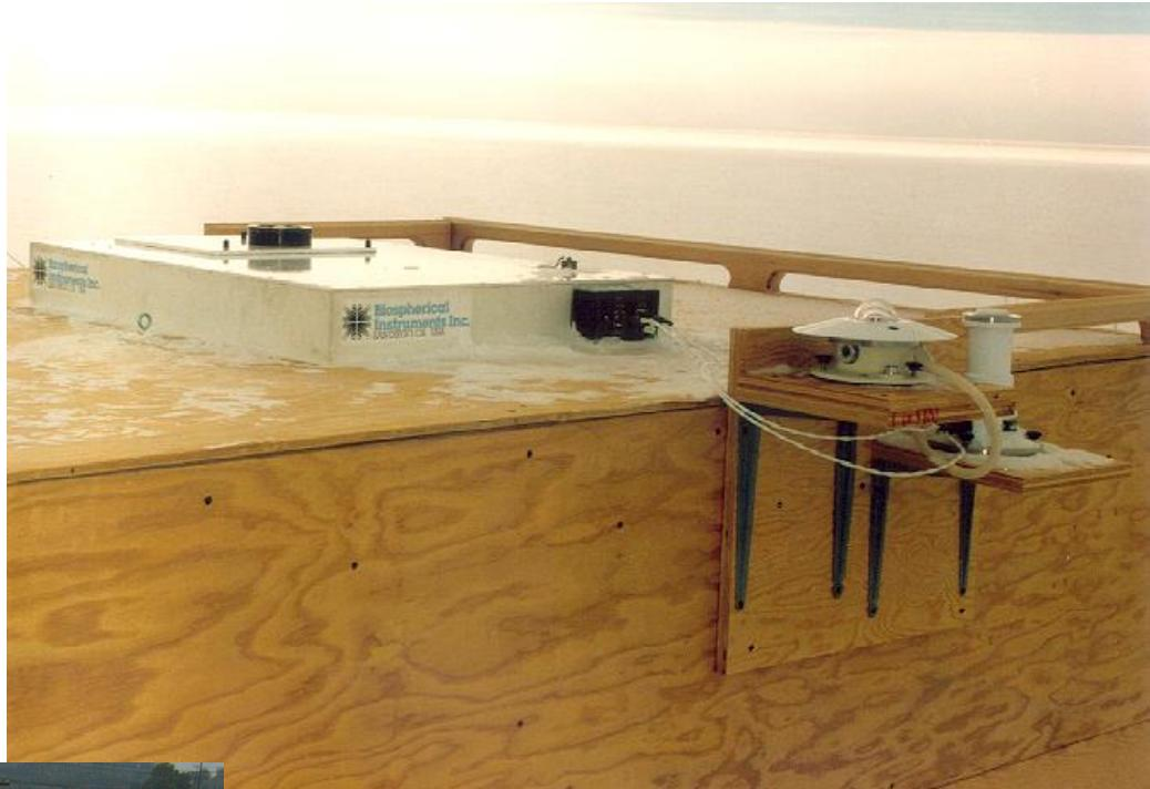
SUV-150B 型は、測定波長 280~600nm でスペクトル分解能 0.63nm を有した全天放射照度計です。全自动で極端な天候にも耐えるよう耐候性の設計がなされています。1987 年 NSF プロジェクトとして南極大陸におけるオゾン欠損量に関する調査をしています。
