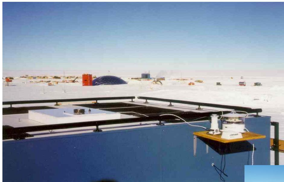
信頼性向上の為に、内部には熱電ヒーター/クーラーを備え器内温度が $\pm 1^{\circ}\text{C}$  以内になるよう制御しています。また長期のデータ品質の向上として水銀光源とタンゲステンハロゲン光源を内蔵し、定期的に絶対校正を行います。
